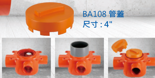
BA108 管蓋 尺寸：4" BA113A 施工步驟 1.防臭總存水匯流盒，安裝在板模上 2.臨時插接5"排水管，阻擋水泥漿。 3.臨時安裝排水管封蓋以阻擋防水膠
