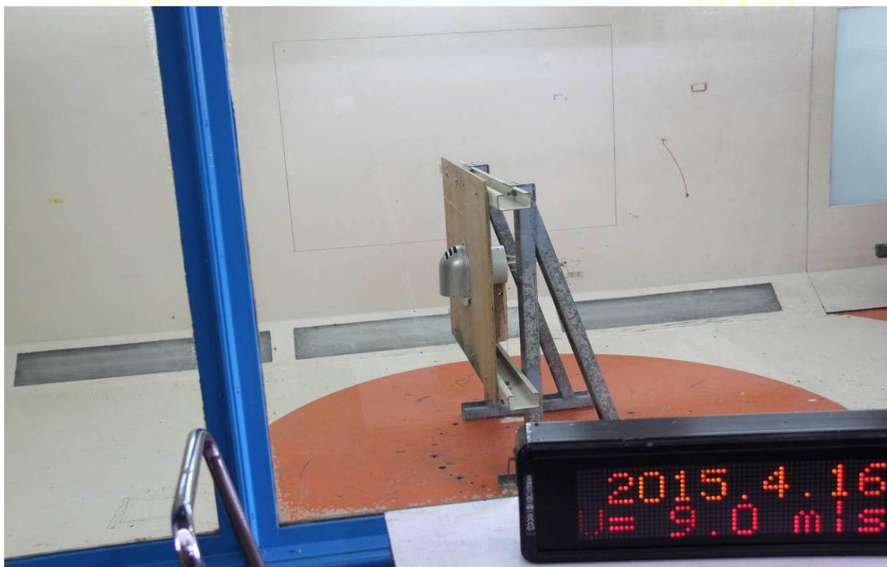
圖 8、PQ324 導流戶外通氣罩迎風吹試下風後狀況 (9.0m/sec)
