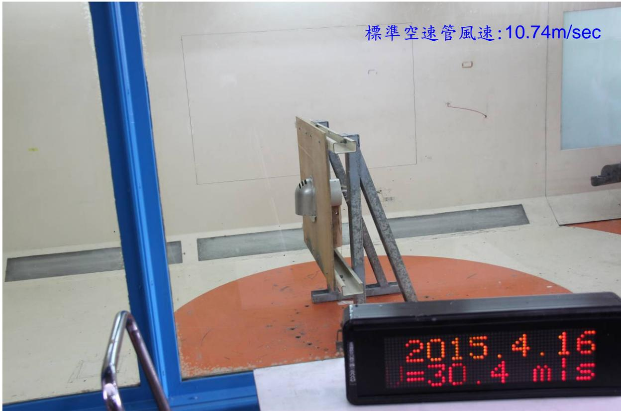
圖 5、PQ324 導流戶外通氣罩迎風吹試狀況 (30.4m/sec)
