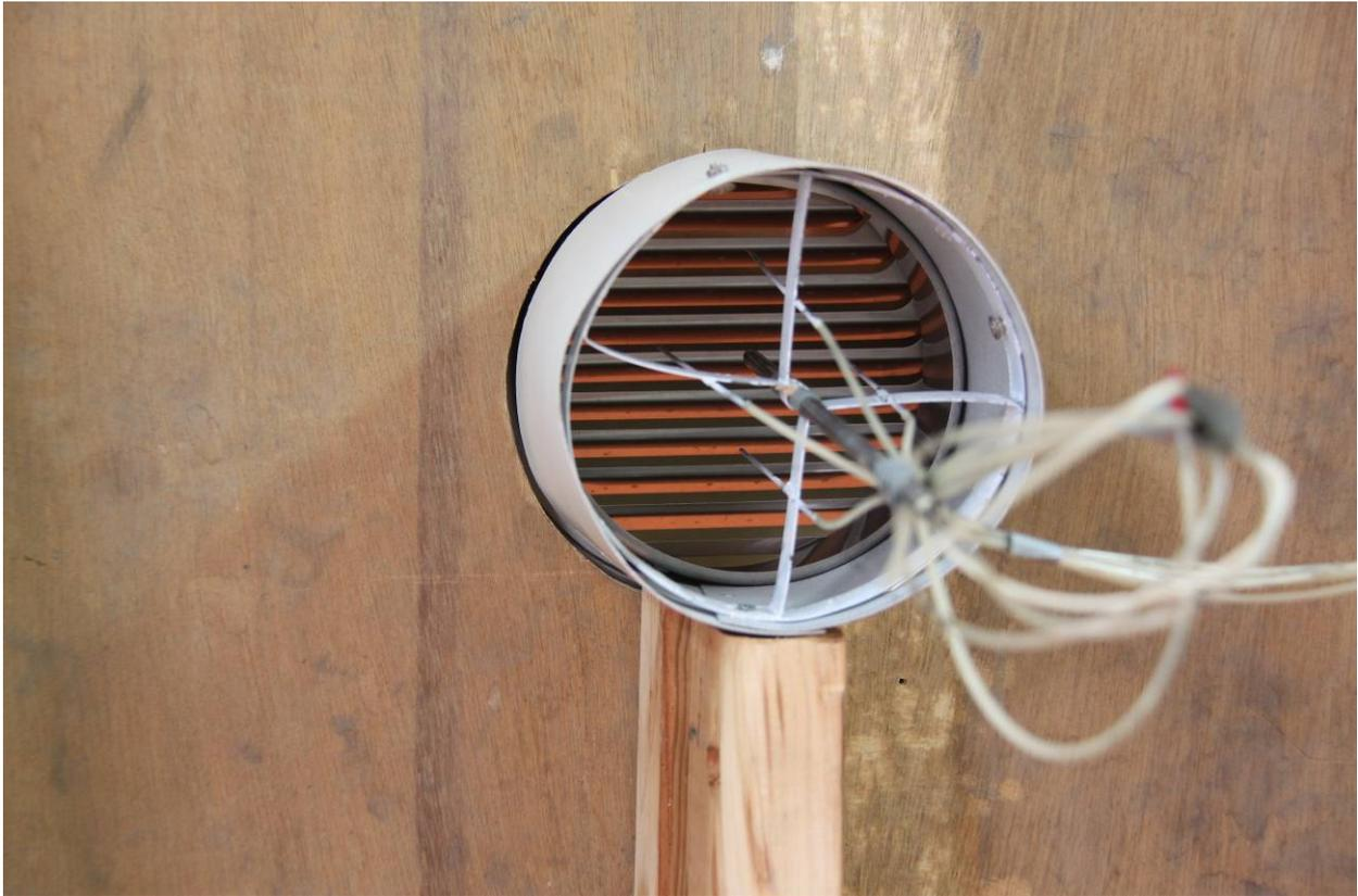
圖 13、它牌導流戶外通氣罩內側入口安裝標準空速管吹試前狀況
