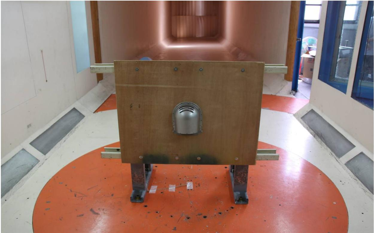
圖1、PQ324 導流戶外通氣罩外側迎風吹試前之狀況
