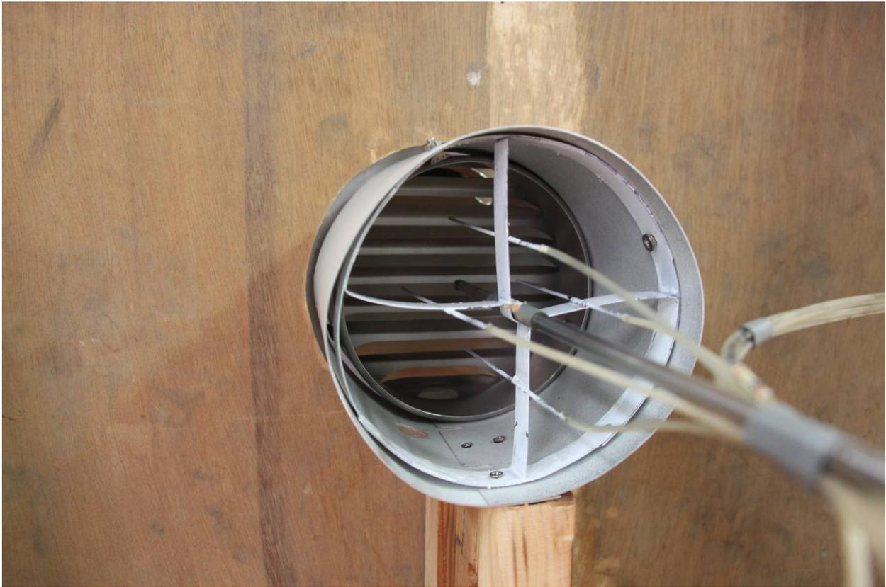
圖 3、PQ324 導流戶外通氣罩內側入口安裝標準空速管吹試前狀況
