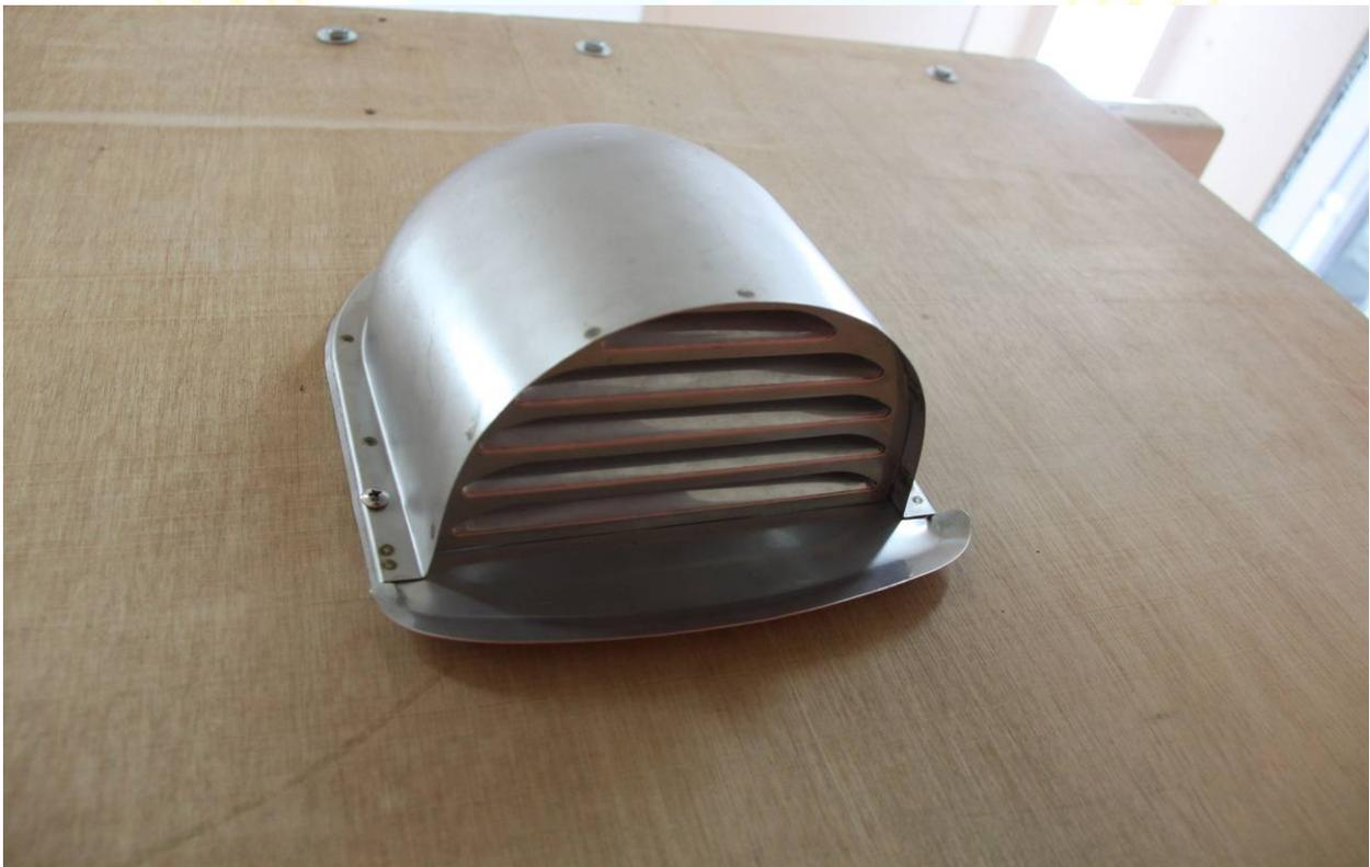
圖 4、PQ324 導流戶外通氣罩外側迎風面下緣排氣口吹試前狀況
