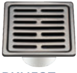
PKU537 尼羅河存水防臭 尺寸：9.5x9.5cm 面蓋： 6mm厚度 管徑：2"(A)
