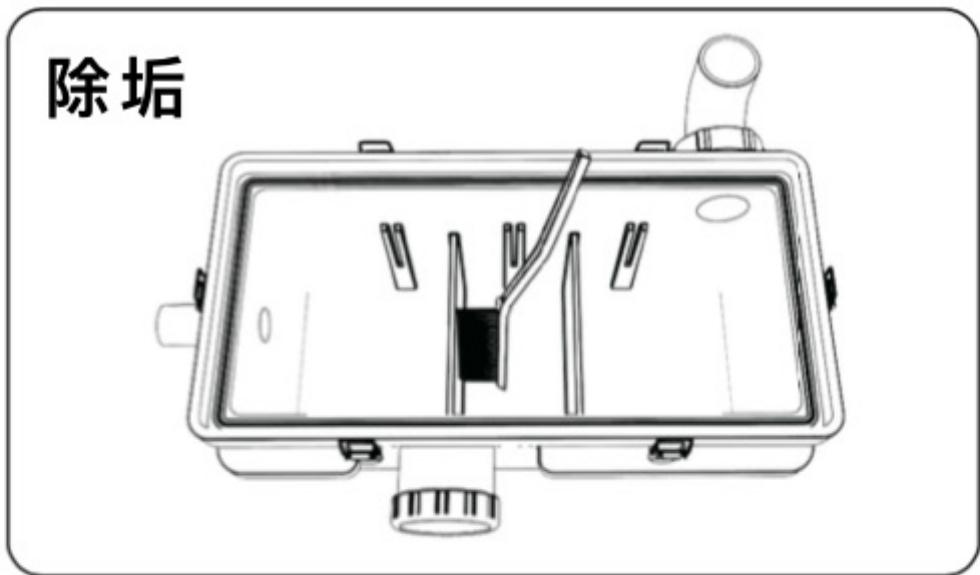
可視槽壁油垢覆著狀況處理，刷洗時可先將三塊活動隔板移除，
