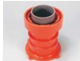
4. 臨時插接2 1/2"排水管測試滿水位。
