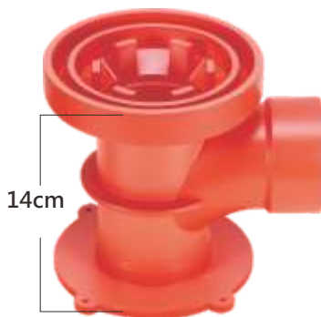
BA129-E 暗排水順水T 口徑：3"x 2½"x2" 材質：PVC
